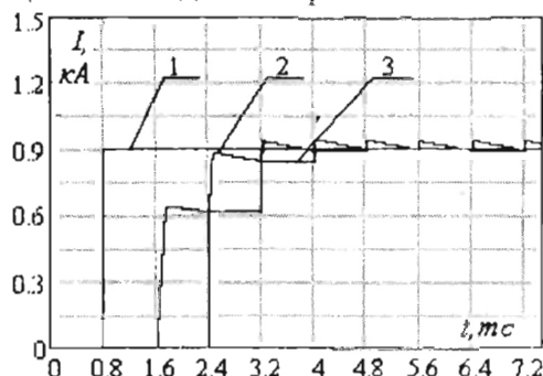
Рис.5.2 в. Кривые переходных процессов в контуре регулирования тока якоря при заторможенном двигателе, скачке задания и компенсации запаздывания: 1-задание тока на входе регулятора; 2-мгновенное значение тока якоря; 3 значение тока якоря на границе ИД
